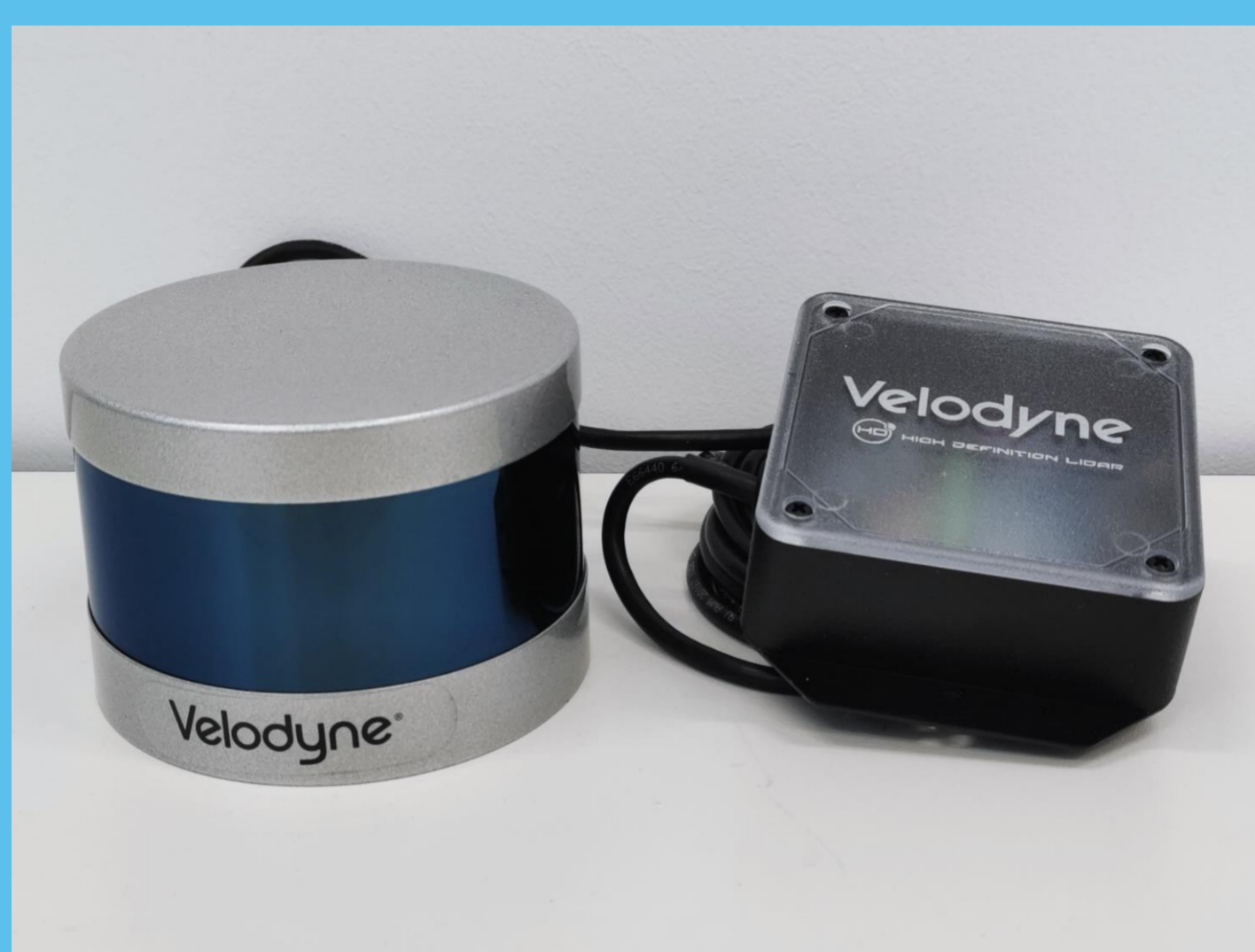
LiDAR-Sensor Puck-Lite der Firma Velodyne
