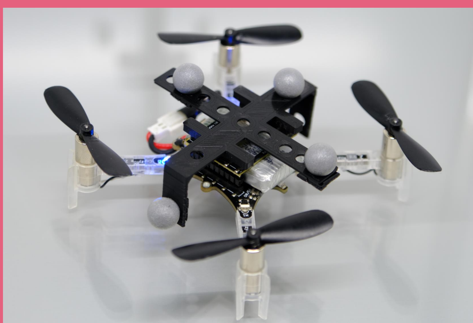
Eingesetzte Drohne: Bitcraze Crazyfly 2.1 mit reflektierenden Markern
