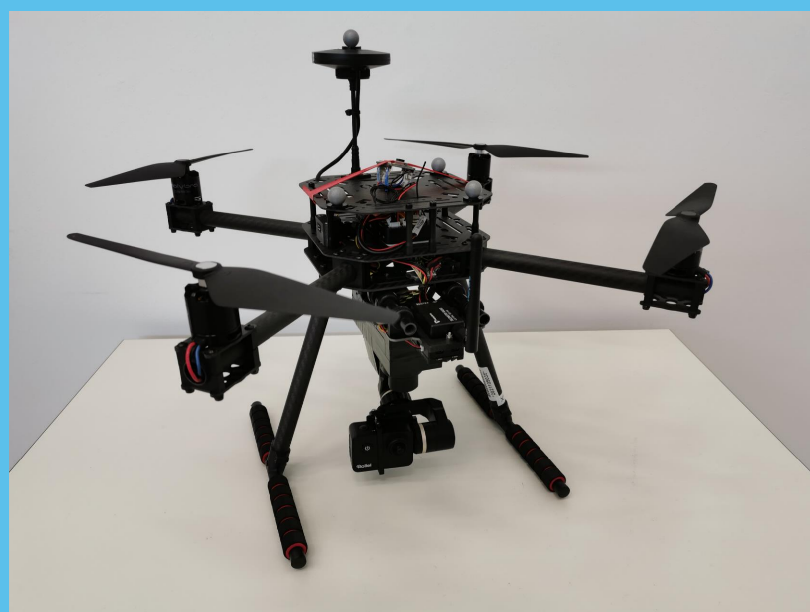
Holybro X500 Individualaufbau mit 3-Achse-Gimbal und Rollei 5S Plus Actioncam
