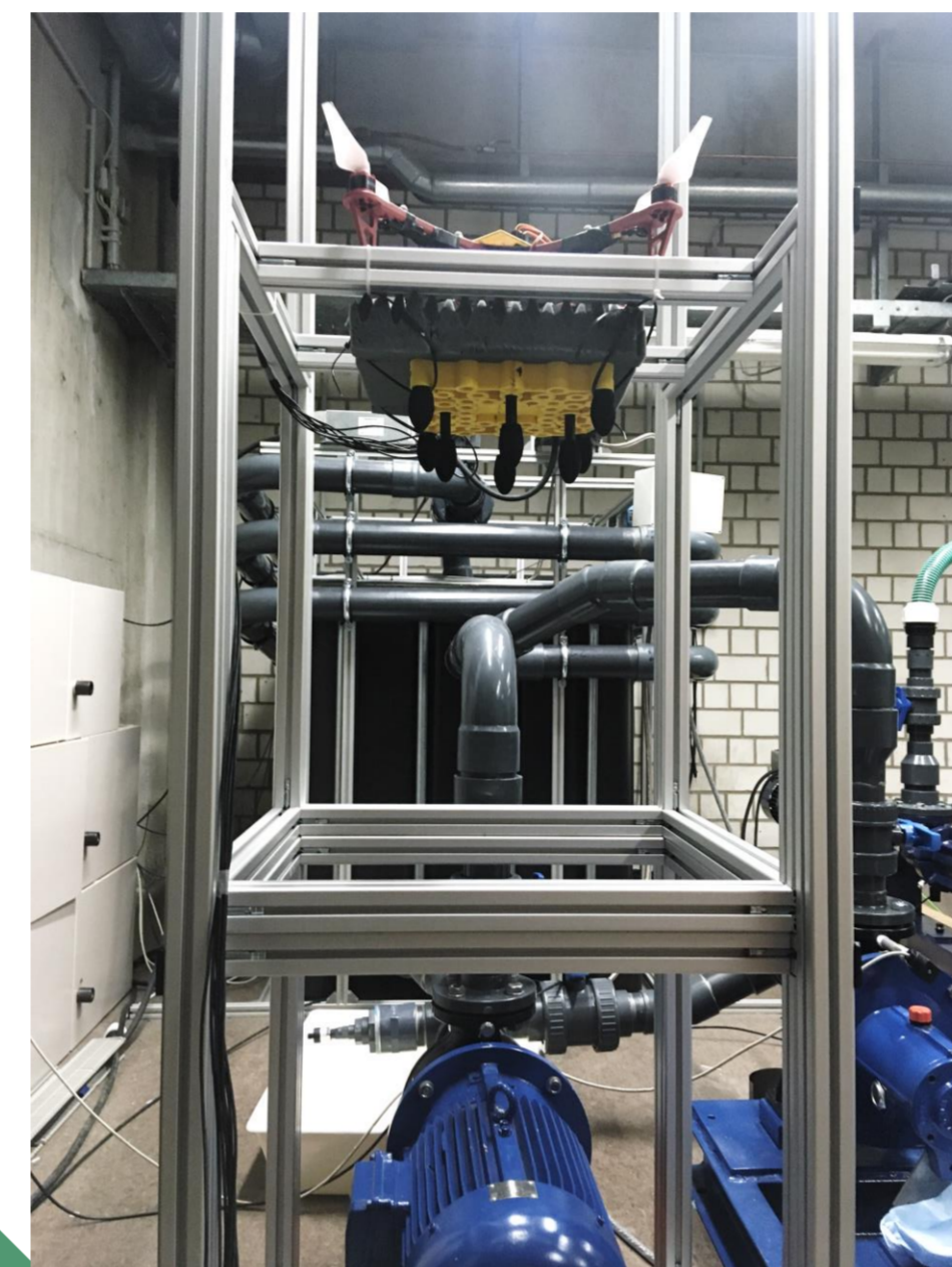
Labora Aufbau der ersten Messungen am Pumpenprüfstand
